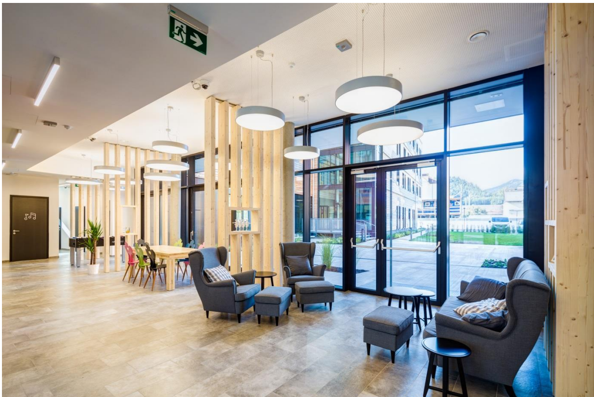
Studierenden-Wohnheim mineroom, Foyer. Die großzügige Verglasung der Allgemeinbereiche reduziert den Bedarf an künstlicher Beleuchtung. An der abgesenkten Decke im Vordergrund sind Bewegungsmelder erkennbar, die die Beleuchtung im Gehbereich ansteuern. (Foto: J. Konstantinov).
