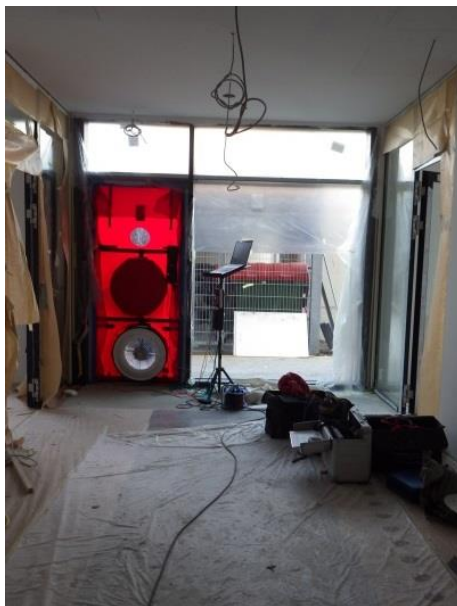
Studierenden-Wohnheim mineroom, Einbau Messeinrichtung in Türelement Erdgeschoss und Messergebnis. (Fotos.: aap.architekten)
