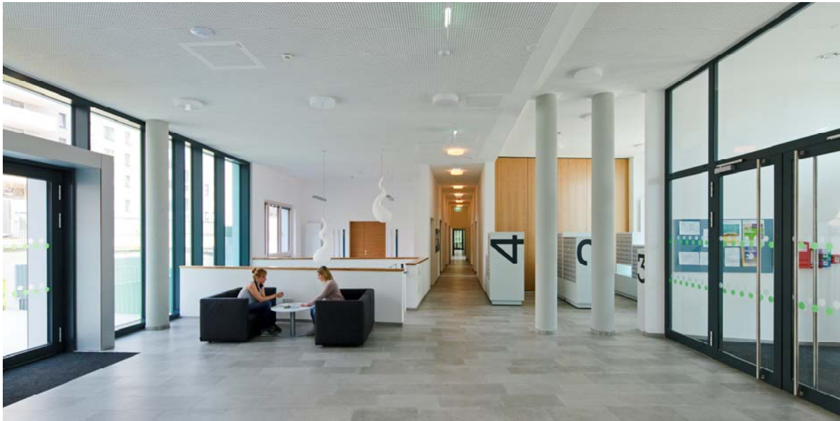
Studierenden-Wohnheim GreenHouse, Foyer. Die großzügige Verglasung der Allgemeinbereiche reduziert den Bedarf an künstlicher Beleuchtung. An der Decke sind Bewegungsmelder erkennbar, die die Beleuchtung ansteuern. (Foto: Rupert Steiner).
