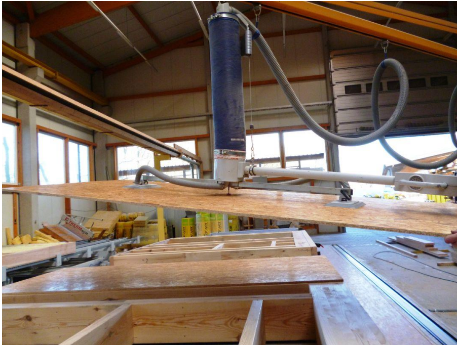
Blick in die Fertigung von Elementen Passivhaus Grundweg, Kaltenkirchen
