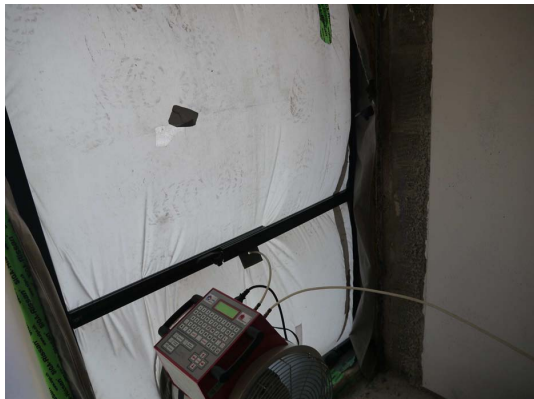
Einbau des Messgerätes in die Eingangstüre
