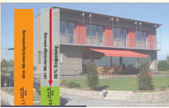
Lüftungsverluste mit und ohne Wärmerückgewinnung
