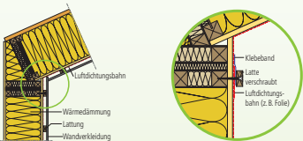
Beispiel: Luftdichter Anschlusspunkt Holzbau Dach/Außenwand
