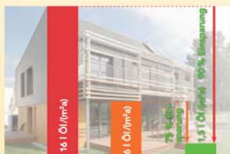
Gebäudebestand Neubau nach EnEV 2009 Passivhaus
