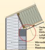
Detail Luftdichtheit Dach/Außenwand Massivbau
